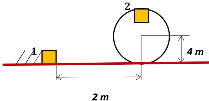
Para calcular la normal en el punto A aplicamos las leyes de newton, teniendo en cuenta que se trata de una rotación:
