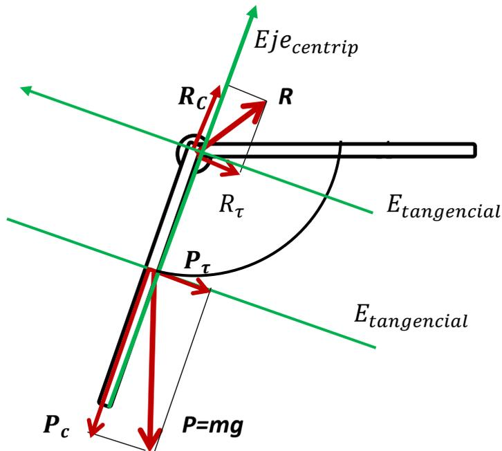
Donde la componente centrípeta de la reacción debe ir hacia el centro de giro ya que la componente centrípeta del peso va hacia afuera. Sobre su componente tangencial no podemos inicialmente suponer un sentido, como en el caso de la componente centrípeta, y la hemos dibujado arbitrariamente. Su valor y sentido se conocerá aplicando las leyes de Newton a ambos ejes:
