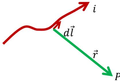
El campo magnético creado por el elemento infinitesimal de corriente en el punto P viene dado por
