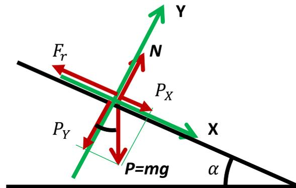
La única fuerza que NO va sobre los ejes es el peso. Por lo tanto, lo descomponemos en sus componentes  $P_X$  y  $P_Y$  aplicando las leyes de los triángulos rectángulos
